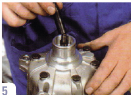
5 Ansetzen der Schutzhülse.
