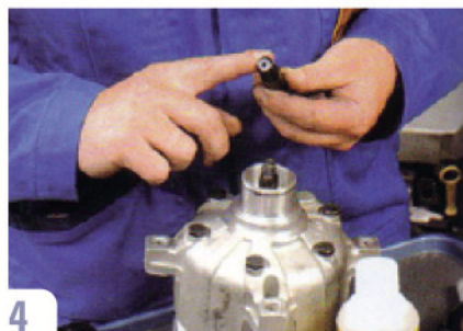
4 Benetzen der Schutzhülse mit Kältemittelöl oder Sil-Lube.
