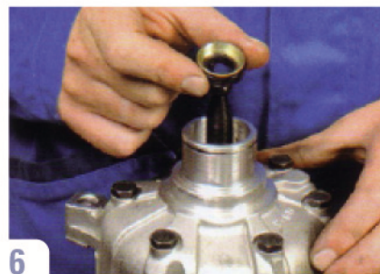
6 Ansetzen des mit Öl benetzten Wellendichtrings.
