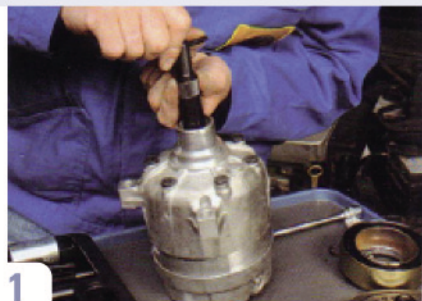
1 Nachdem die Kupplungsgruppe entfernt wurde, wird das Spezialwerkzeug zum Entfernen der Wellendichtung eingesetzt.
