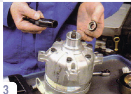
3 Der alte Wellendichtring wurde entfernt.
