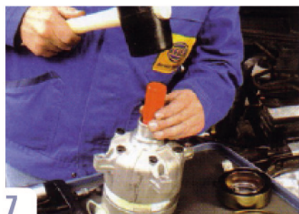
7 Einpressen des Wellendichtrings mit Hilfe einer Hydraulikpresse oder des Gummihammers in Verbindung mit dem Spezialwerkzeug.
