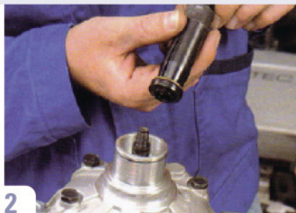
2 Ausgebauter Wellendichtring am Spezialwerkzeug.
